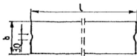
Rys. 1. Wymiarowanie krawężników
